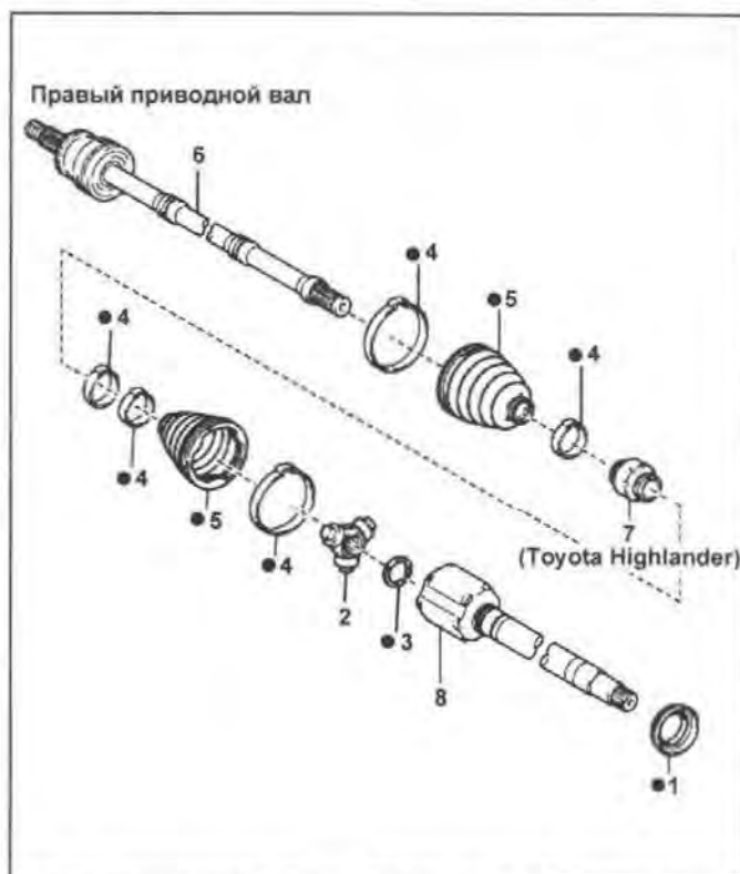
Передние приводные валы. 1 - пыльник, 2 - тройной шарнир, 3 - стопорное кольцо, 4 - хомут, 5 - чехол, 6 - приводной вал, 7 - демпфер, 8 - обойма внутреннего шарнира.
