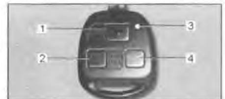
Lexus, Toyota Harrier (модели без электропривода задней двери). 1 - запирание дверей, 2 - отпирание дверей, 3 - светодиод, 4 - кнопка "PANIC".
