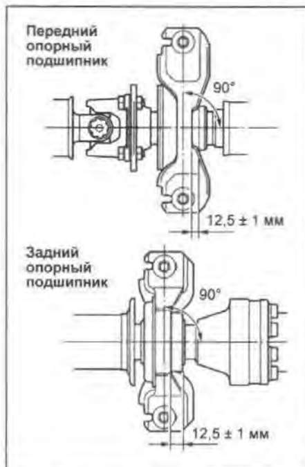
Углы установки карданных валов и заднего редуктора.
