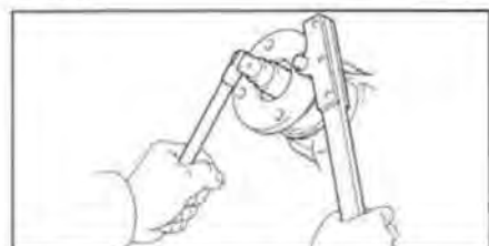
в) С помощью съемника снимите фланец заднего редуктора.
